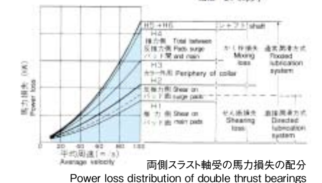
図1 通常潤滑両側スラスト軸受における馬力損失の発生部位 Fig.1—Location of power loss on double thrust bearings of flooded lubrication
